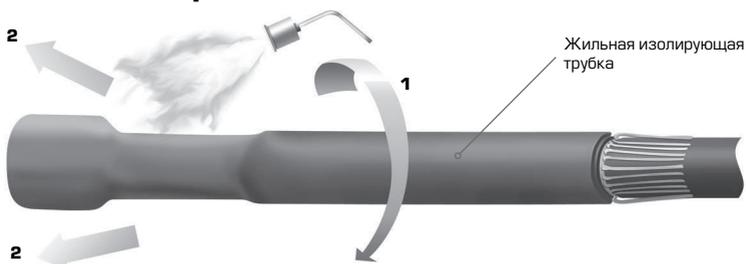
**9.1** Поочередно для каждого конца кабеля с изоляцией из сшитого полиэтилена надвинуть и усадить на жилы жильные изолирующие трубки. Трубки располагать вплотную к срезу наружной оболочки.
