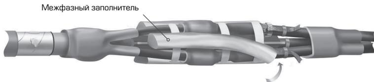
**14.1** Снять антиадгезионный защитный слой с узких граней мастики для заполнения межфазного пространства. Поместить межфазный наполнитель между жилами таким образом, чтобы широкое основание было обращено наружу.
