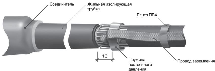
**12.1** Растянуть в ширину конец провода заземления на длине 90-100 мм.
