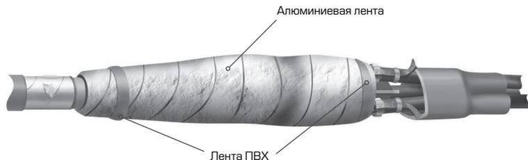
**16.1** Поверх внутреннего кожуха произвести намотку алюминиевой ленты с перехлестом витков 15-20 мм. Намотку необходимо начинать от края **малых** пружин постоянного давления кабелей с изоляцией из сшитого полиэтилена и закончить на металлической оболочке маслопропитанного кабеля с заходом на нее на 20 мм. Концы алюминиевой ленты зафиксировать изоляционной лентой ПВХ.
