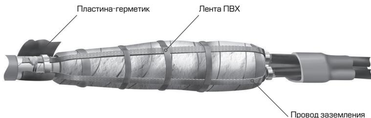
**17.1** Распрямить и вытянуть вдоль монтируемой муфты три провода заземления, закрепленные на кабелях из сшитого полиэтилена, до бронелент кабеля с бумажной маслопропитанной изоляцией. Закрепить их бандажом из 2-3 витков проволоки на облуженных поверхностях бронелент.
