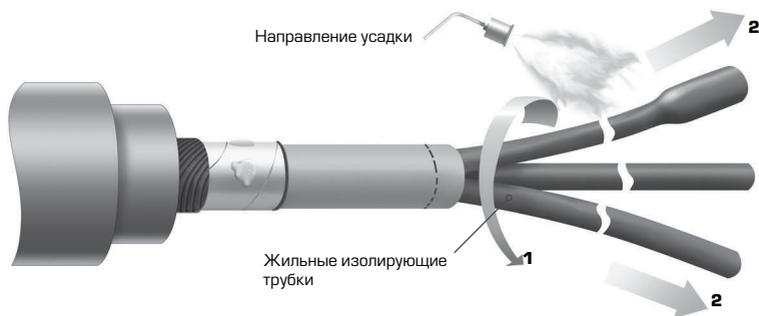
**3.1** Надеть на жилы кабеля с бумажной маслопропитанной изоляцией жильные изолирующие трубки и сдвинуть их до упора в основание разделки.
