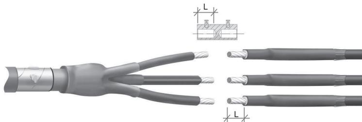
**10.1** Удалить с концов жил кабеля с бумажной маслопропитанной изоляцией и кабелей с изоляцией из сшитого полиэтилена изоляцию на длине, равной глубине отверстия в болтовом соединителе.
