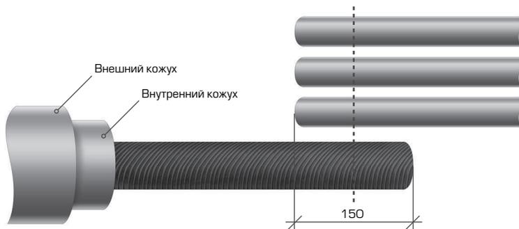
**1.1** Распрямить конец кабеля с бумажной маслопропитанной изоляцией и три конца кабелей с изоляцией из сшитого полиэтилена на длине 2000 мм, очистить их от загрязнений и расположить таким образом, чтобы напротив конца кабеля с бумажной маслопропитанной изоляцией были три конца кабелей с изоляцией из сшитого полиэтилена с перехлестом в 150 мм. По центру перехлеста провести маркировочную линию, после чего обрезать концы кабелей по разметке.
