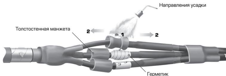
**11.1** Надеть на жилы кабеля с бумажной маслопропитанной изоляцией толстостенные изолирующие манжеты и сдвинуть их на время монтажа соединителей в сторону **малой** перчатки до упора.
