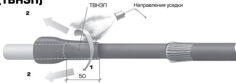
**8.1** Обезжирить участки изоляции из сшитого полиэтилена, используя х/б салфетку и бензин-растворитель, начиная от конца жилы в направлении полупроводящего экрана по изоляции. **Салфетку х/б использовать только однократно для каждой жилы.**
