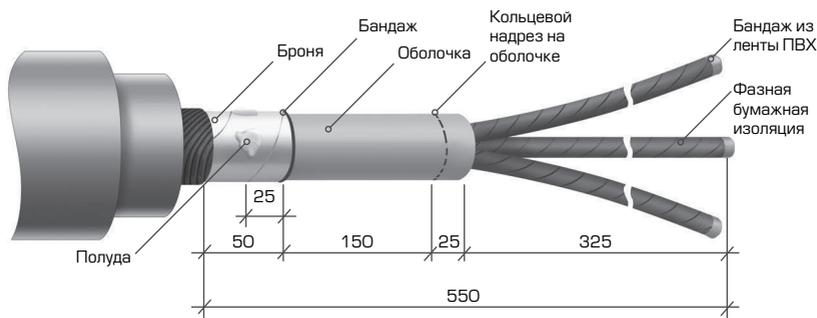
**2.1** Удалить с конца кабеля с бумажной маслопропитанной изоляцией защитный покров, броню, металлическую оболочку и слой поясной изоляции согласно размерам, указанным на рисунке. Проверить бумажную изоляцию на влажность. Монтаж муфты на кабеле с увлажненной изоляцией категорически запрещается. Удалить жгуты межфазного заполнения. При наличии цветных маркировочных лент на фазной бумажной изоляции ленты не удалять.
